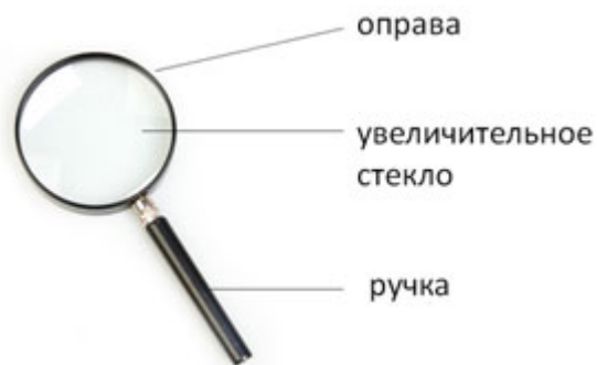
Рис. 1. Строение ручной лупы
